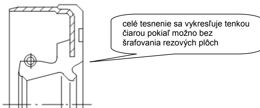
Obr. 6.10 Podrobné zobrazenie tesnenia
