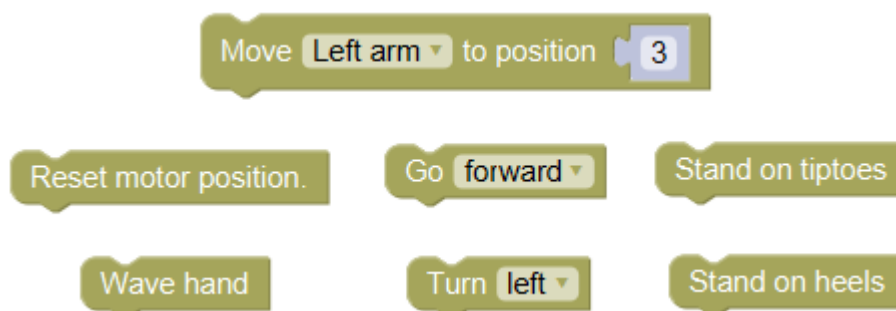
Obr. 6.10: Bloky pre ovládanie servomotorov
