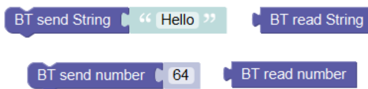
Obr. 6.13: Bloky pre sériovú komunikáciu prostredníctvom Bluetooth
