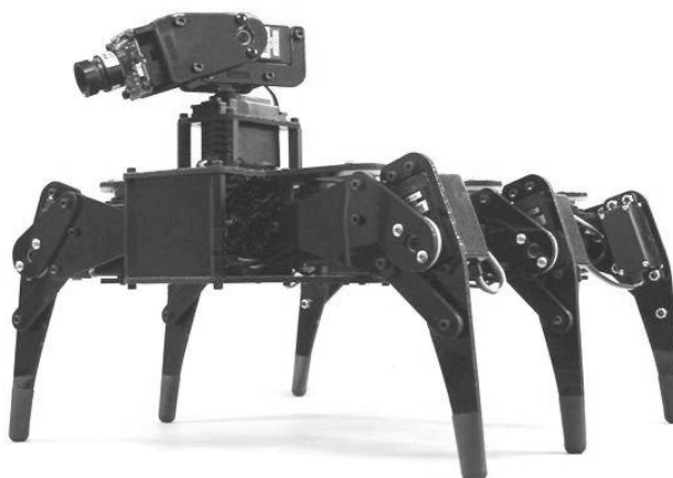
Obr.8.13 Príklad technickej realizácie 6-nohého kráčajúceho podvozku
