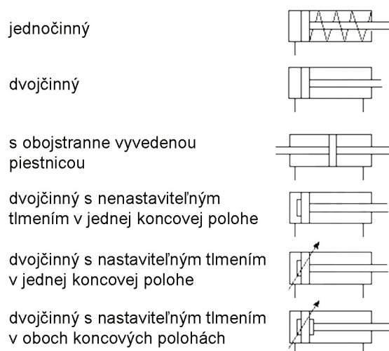
Obr. 48 Priamočiare pneumatory
