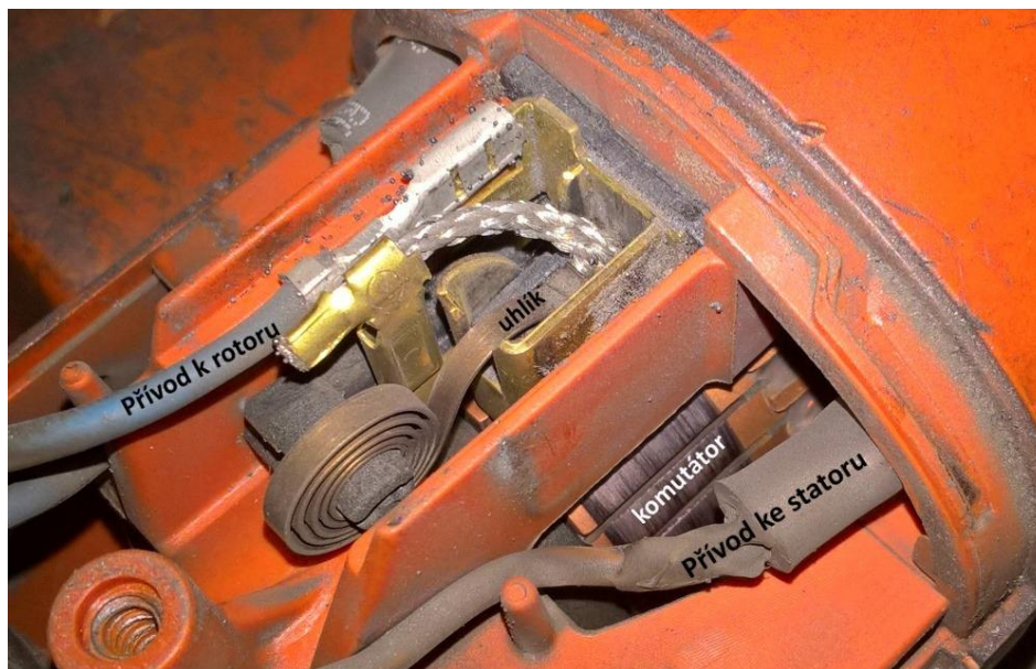
Obr. 49 Detail pripojenia motora. Na obrázku možno vidieť privody na stator a rotor, komutátor a uhlík
