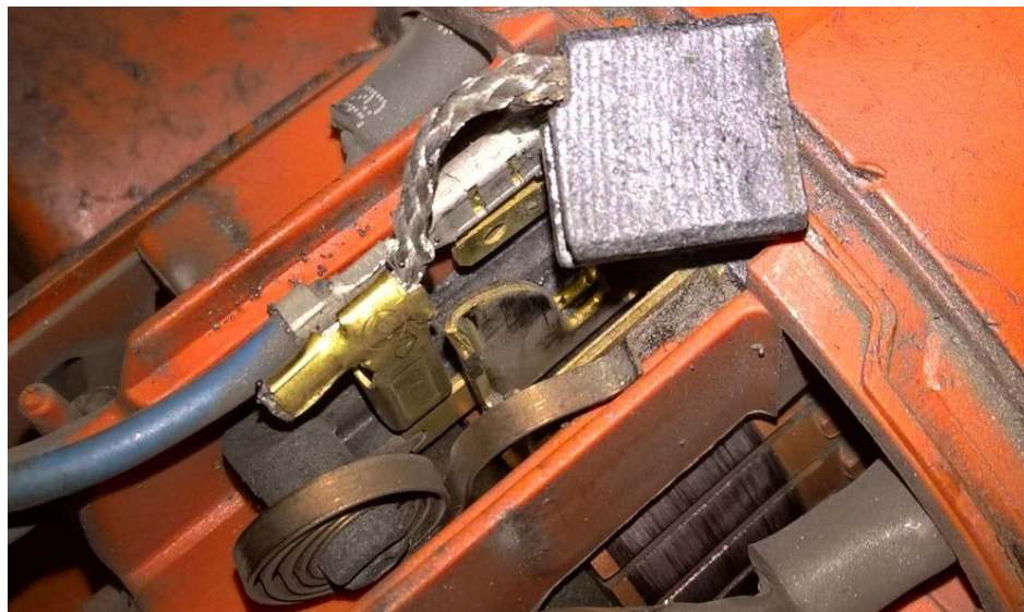
Obr. 49 Detail pripojenia motora. Na obrázku možno vidieť privody na stator a rotor, komutátor a uhlík
