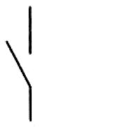
mechanický tlakový spínač
