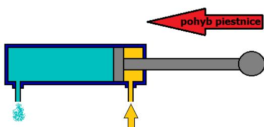
48b Prečo sa dvojčinný valec po pripojení dvoch rovnakých tlakov na obe jeho prípojky začne vysúvať?
