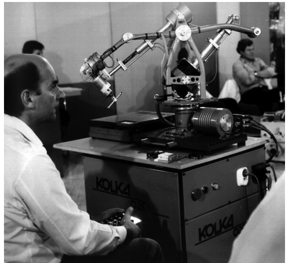
Kolka 025, prvý čsl. robot s mikroprocesorovým riadiacim systémom
